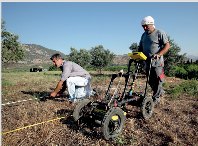
Abb. 3. Geophysikalische Messungen auf dem Çukuriçi Höyük in Ephesos durch S. Seren, ZAMG (Foto: ÖAW-ÖAI/N. Gail)
