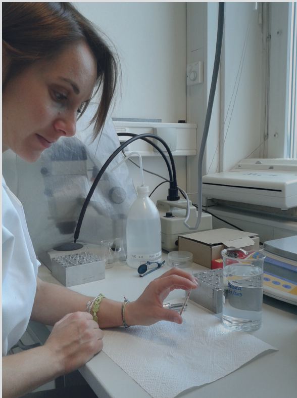
Abb. 3. Instrumentale Neutronenaktivierungsanalyse besitzt großes Potential für Provenienzstudien von Niltonen; hier werden Proben aus Sai im Labor der TU Wien/Atominstitut von G. D’Ercole aufbereitet (Foto: J. Sterba, ©AcrossBorders Projekt)
