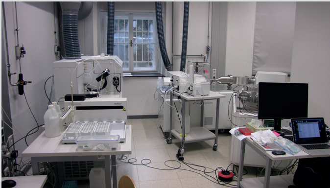
Abb. 4. Die LA-ICP-MS-Einheit am NAWI Graz Geozentrum der Karl-Franzens Universität und TU Graz (Foto: M. Brandl)
