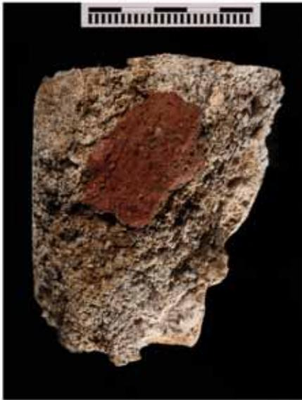
Abb. 8: Putzaufbau von Stuckgesims Nr. IIIa
