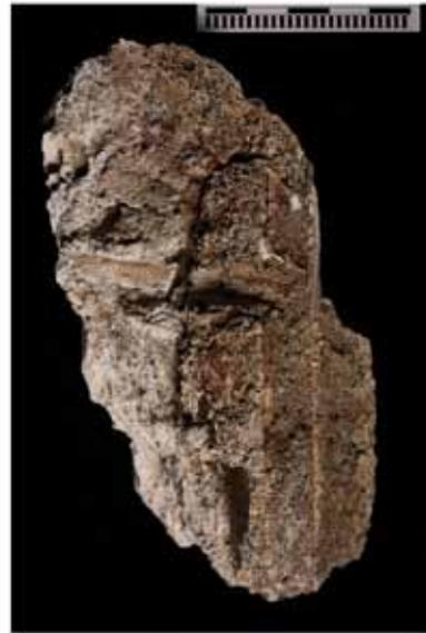
Abb. 9: Abdruck von Metallstift und ältere Malereischichten an Stuckgesims Nr. IIIa
