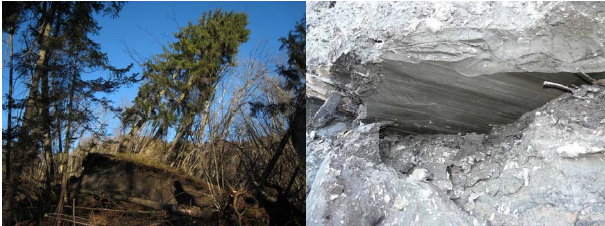
Abb. 4 und 5: Links eine aufsteigende Schollen mit gegen die Bewegungsrichtung kippenden Bäumen bestätigt die Modellvorstellung, rechts der Ausbiss einer Scherfläche in einer Schürfrube in Form und Richtung der oben beschriebenen Schaufelfläche und der Modellvorstellung in Abb. 6.
