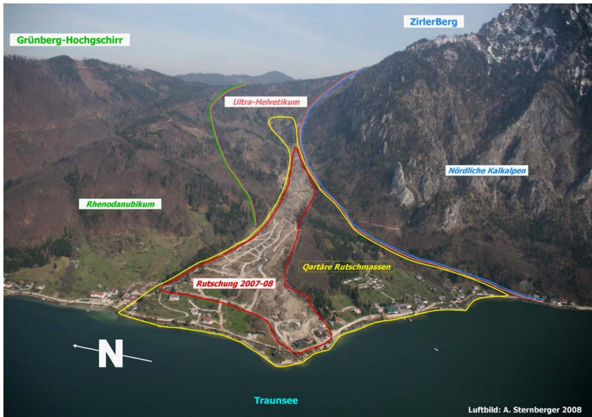
Abb. 1: Der Gschlifgraben von W mit den tektonischen Großeinheiten und dem gewaltigen postglazialen Schuttkegel
