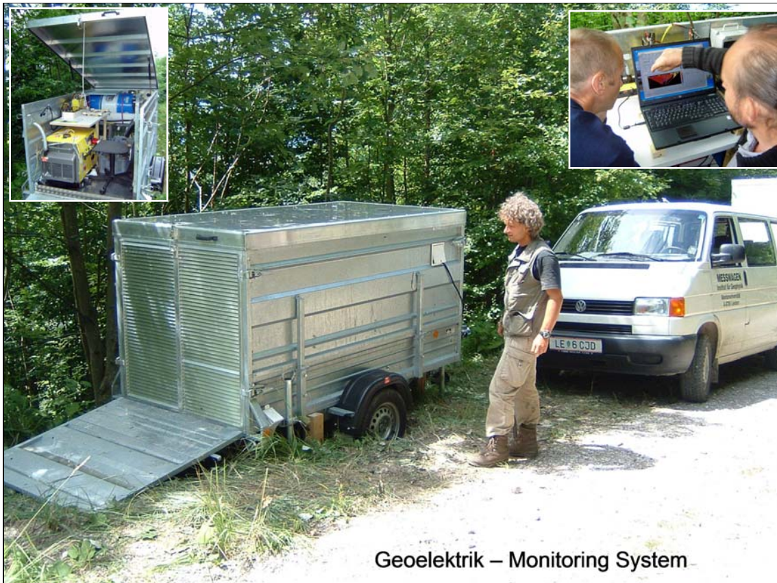
Abb. 8: Geoelektrische Monitoringanlage im Feldeinsatz über den oberen Gschlifgraben; im Anhänger befinden sich die geoelektrische Messapparatur samt automatischer Steuerung und ein Motor-Generator zur Stromversorgung.
