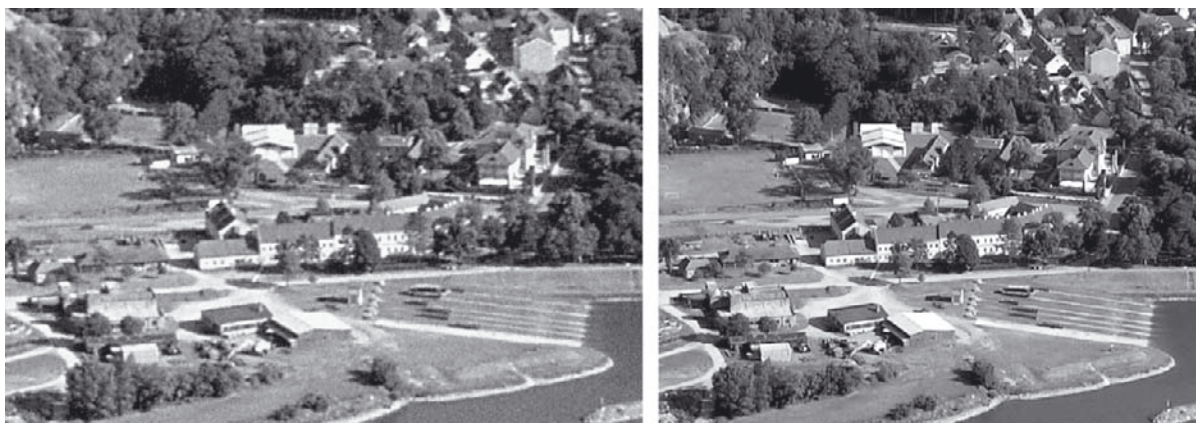
Abb. 16: Gegenüberstellung von Ausschnitten eines mit hoher Auflösung gescannten analogen (links) und eines mit einer digitalen 12MP-Kamera aufgenommenen Bildes (rechts).
