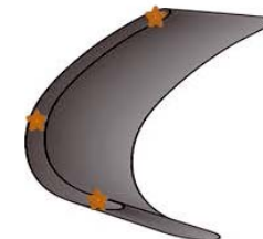
Abbildung 48: Änderung der Interpolationsparameter von Isotrop (Kugelfunktion) auf Anisotrop; gelbe Sterne symbolisieren Eingangsdatenpunkte.
