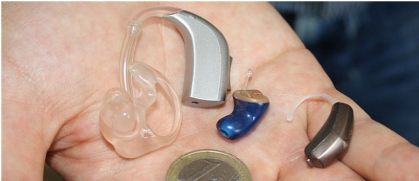
Hörgerätgehäuse werden nur mehr mittels 3D-Druck erzeugt.
