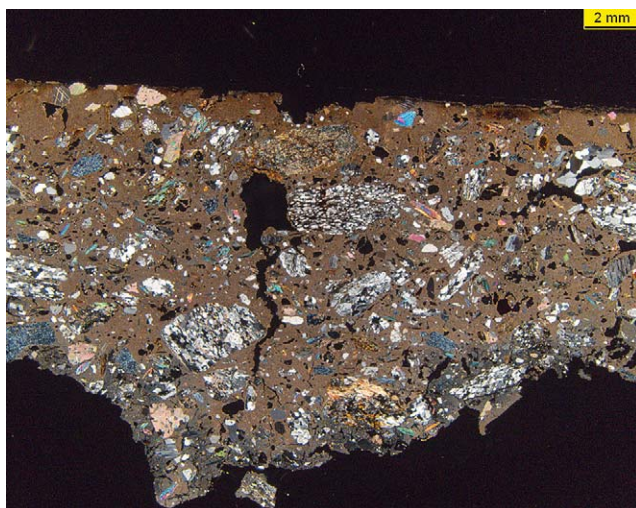
6 Dünnschliff des Wandputzes Kammer 5a, Tonnengewölbe (P2/2009)
