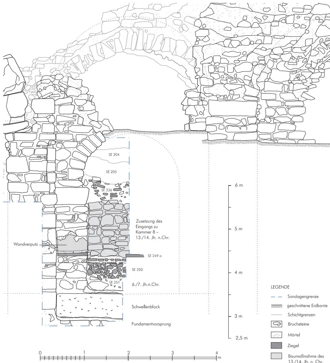
Abb. 14 Sondage 1/2010, Südprofil, M. 1 : 50
