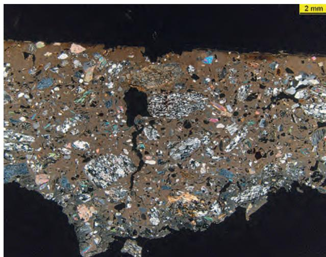
6 Dünnschliff des Wandputzes Kammer 5a, Tonnengewölbe (P2/2009)
