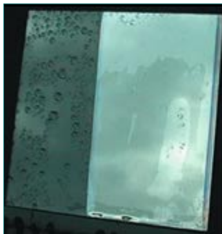
Abbildung 3: Hydrophile Beschichtung (rechts) mit TiO 2 auf Floatglas ( www.wopag.uni-bayreuth.de )
