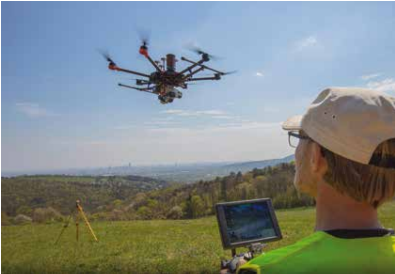
8 Hochauflösende LiDAR-Geländevermessung durch C. Kurtze mit Luftdrohnen am Bisamberg | High-resolution LiDAR terrain survey by C. Kurtze with aerial drones at the Bisamberg (© ÖAW-ÖAI, J. Kreuzer)
